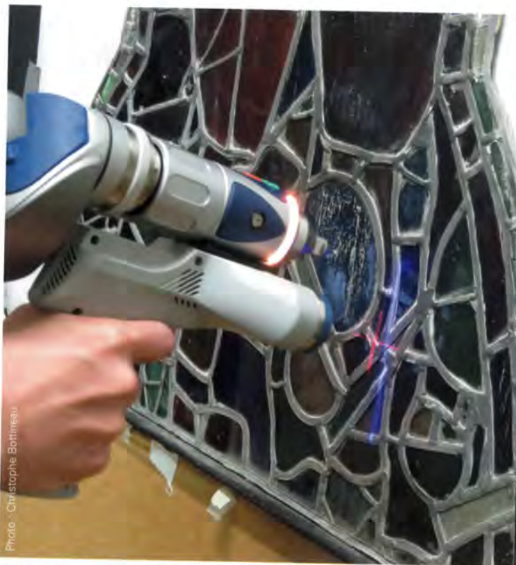
↑ Scan 3D du vitrail original pour la création de la matrice
